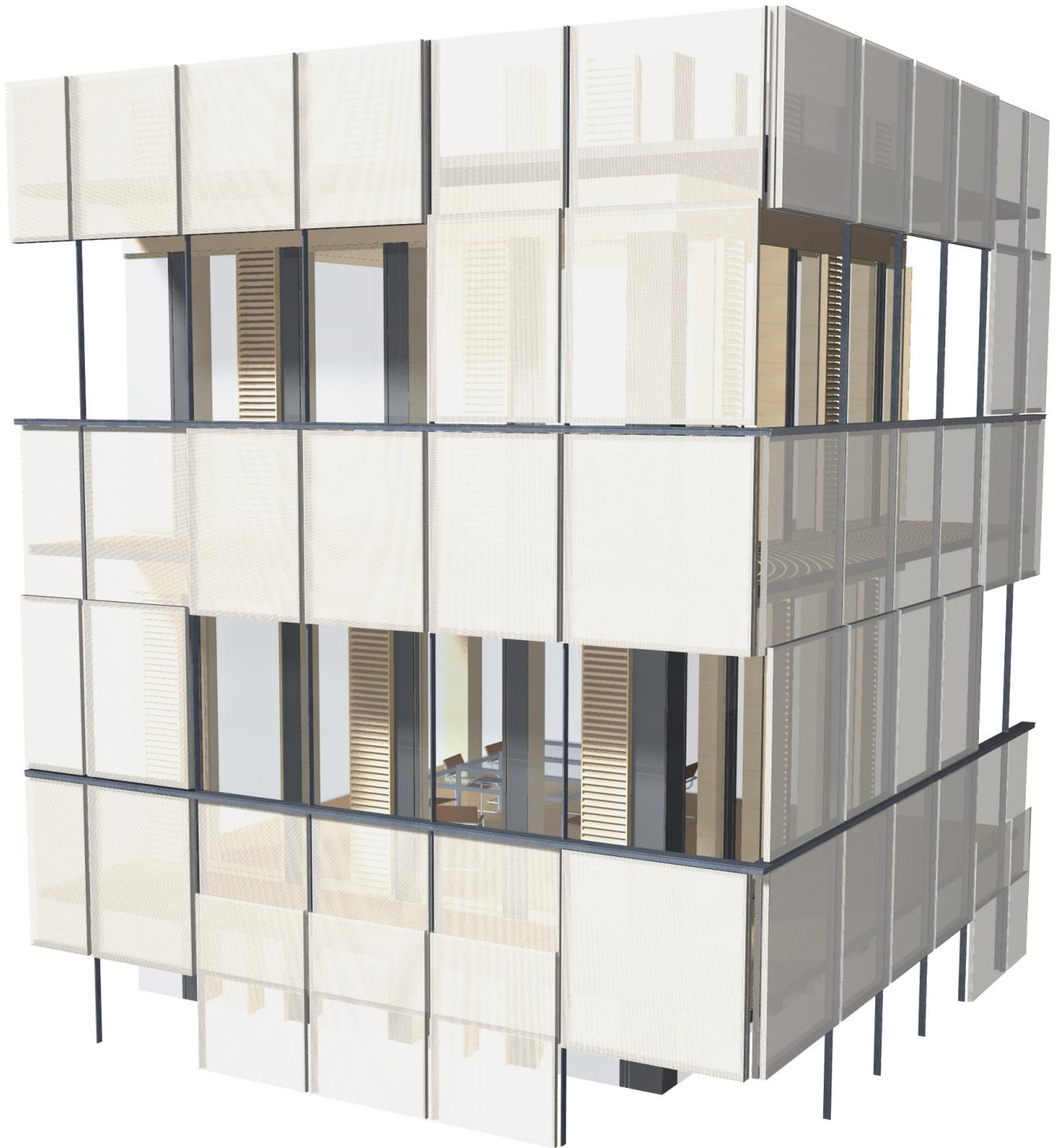
Abb. 4.72 Perspektive: Vertikal verschiebbare Textilsegel
