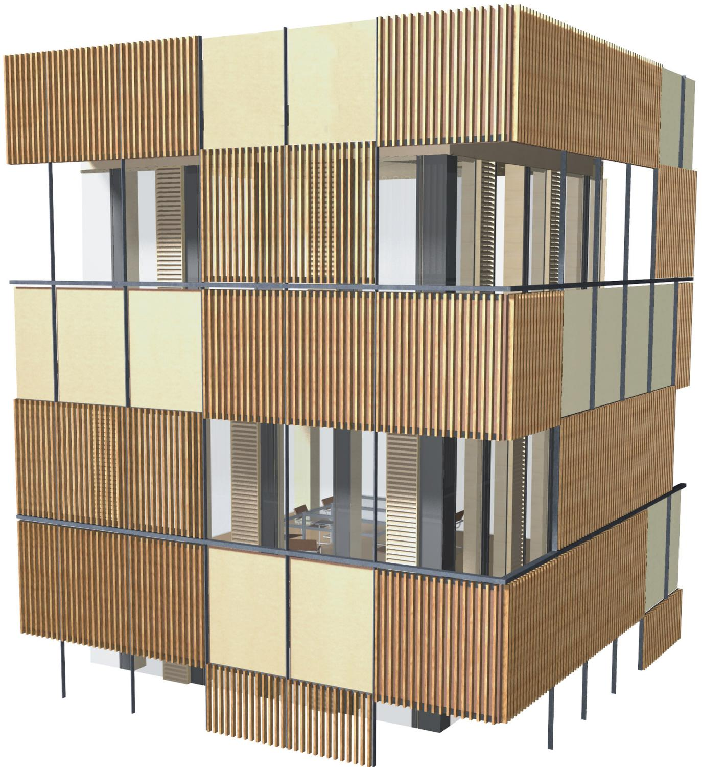
Abb. 4.75 Perspektive: Vertikal verschiebbare Holzlamellen und Holzleichtbetonbrüstungen
