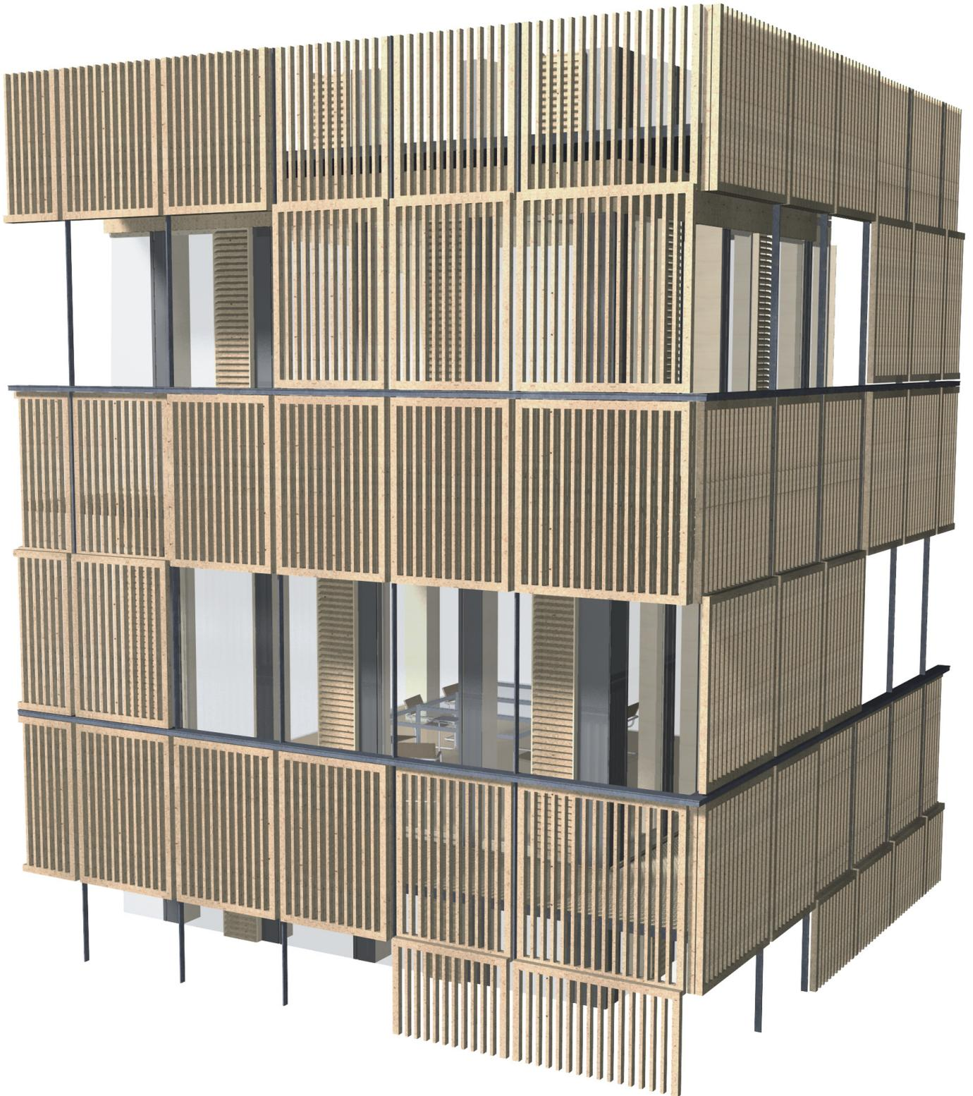
Abb. 4.69 Perspektive: Vertikal verschiebbliche Holzleichtbetonlamellen
