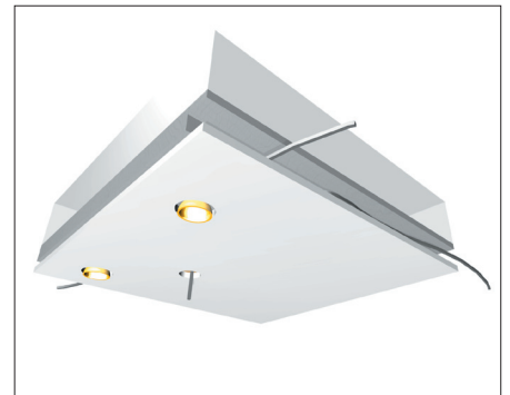
Abb. 4.50 Elektroinstallation: Fertig installierte Decke mit Deckenauslass und Einbauleuchten.
