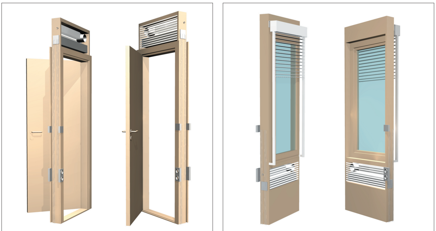
Abb. 3.70 Vorgefertigte Ausbauelemente mit integrierten Technikkomponenten für Heizung und Lüftung sowie Schaltern und Steckdosen für Strom und Daten.
