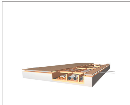
Abb. 3.56 Einbaufolge eines vorgefertigten Boden-Decken-Elements mit vorkonditioniertem Hohlraum: Die Leitungen und Rohre werden nachträglich eingelegt und angeschlossen. Die Zugänglichkeit erfolgt über abnehmbare Bodenplatten.
