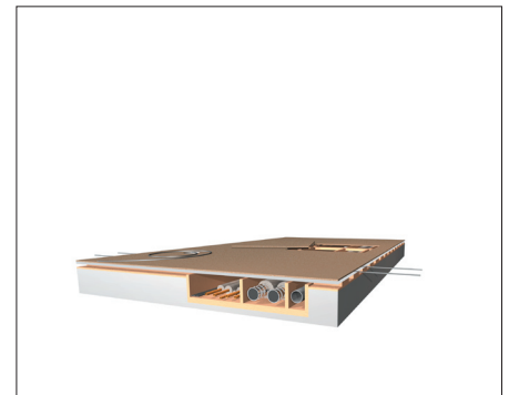
Abb. 3.56 Einbaufolge eines vorgefertigten Boden-Decken-Elements mit vorkonditioniertem Hohlraum: Die Leitungen und Rohre werden nachträglich eingelegt und angeschlossen. Die Zugänglichkeit erfolgt über abnehmbare Bodenplatten.
