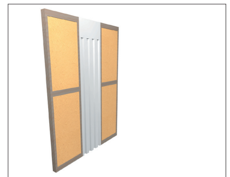
Abb. 4.41 Hohlräume: Einbringen der vorgefertigten Elektroinstallationsplatte. Zur Decke ist die Massivbauplatte abgeschlossen um eine mögliche Brandweiterleitung zu verhindern. Die Hohlräume sind so dimensioniert, dass eine Standardhohlraumdose Platz findet.
