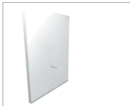
Abb. 4.43 Beplankung: Die Wand wird für das Oberflächen-finish und aus schall- und brandschutztechnischen Gründen mit einer Gipskarton-, Gipsfaser- oder Brandschutzplatte beplankt. Am Boden verläuft eine reversibel abnehmbare Fußleiste.
