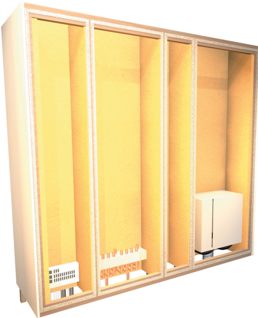
Abb. 4.14 Montage der Technikkomponenten: Vor die Rohrleitungen werden die dazugehörigen Technikkomponenten platziert. Sie sind von den Leitungen und Kabeln durch eine bereits im Werk passgenau gefertigte und auf der Baustelle nur noch eingehängte bzw. eingeklemmte Wärme- und Brandschutzdämmung getrennt. Die Technikkomponenten sind mit schallentkoppelten Halterungen am Schachtrahmen individuell befestigt. Für den rauchdichten Abschluss sorgt ein Dichtband, das bei Brand aufschäumt und die Fuge verschließt.
