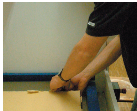
Abb 4.8 Modellbau von vorgefertigten Hohlräumen in einer Dämmplatte: Ein drei-dimensionales CAD-Modell wird vom Rechner auf die 3D-CNC-Fräse übertragen.
