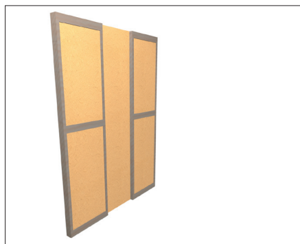
Abb. 4.40 Dämmung: Schallschutzdämmung in den Zwischenräumen
