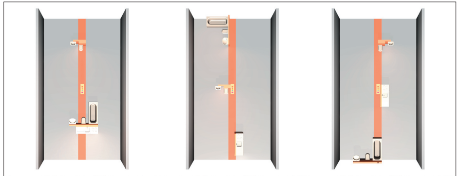
Abb. 3.17 Möglichkeiten zur Anordnung der horizontalen und vertikalen Installations-Trassen und ihre Auswirkung auf die Grundrissgestaltung
