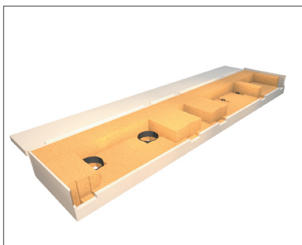
Abb. 4.20 Brandschutzmanschetten: Im Deckenschott werden rohrleitungsspezifische Brandschutzmanschetten angebracht. Diese schäumen im Brandfall selbstständig auf und verschließen die Rohrleitung, so dass eine Brandweiterleitung verhindert wird. Beidseitig angeordnete Brandschutzmanschetten verhindern, dass brennbare Rohrleitungen von einer Seite aus den Deckenschott durchbrennen, während die dem Brand gegenüberliegende Rohrabschottung noch nicht ausgelöst hat. Für Elektro- und Datenkabel werden spe-
