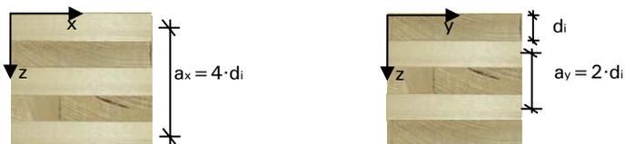
Abb. 5-10: Ermittlung  $a_x$  bzw.  $a_y$  einer Fünfschichtplatte
