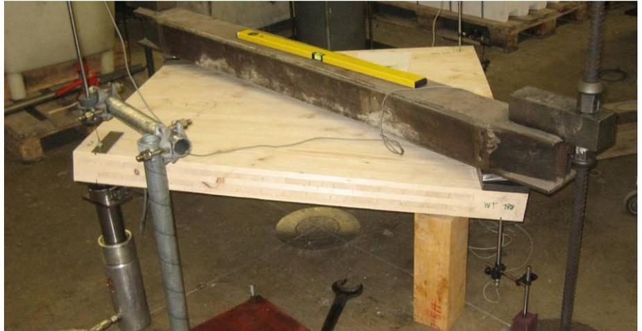
Abb. 5-78: Verdrillung des Prüfkörpers Drill\_2\_85
