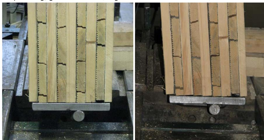
Abb. 5-96: Unverformtes Element und Schubverformung am Wandfuß
