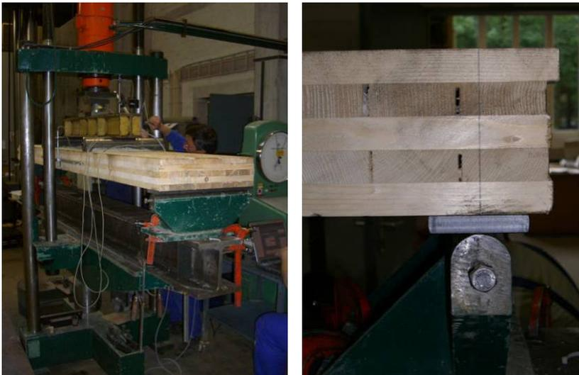
Abb. 5-86: Einbau der Prüfkörper und Auflagerdetail
