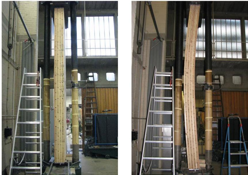
Abb. 5-97: Einbau- und Belastungszustand
