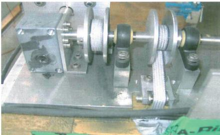
**Bild 4.25** Abnutzungsspuren am Getriebe
