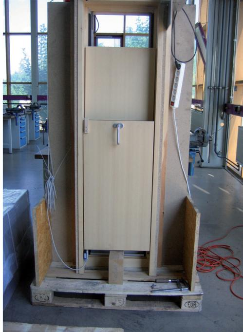
Prüfenster mit unterer und oberer Spaltlüftungsstellung
