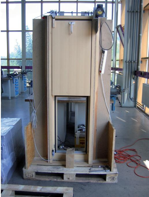
Prüfensteraufbau mit beiden Flügeln in geöffneter Stellung
