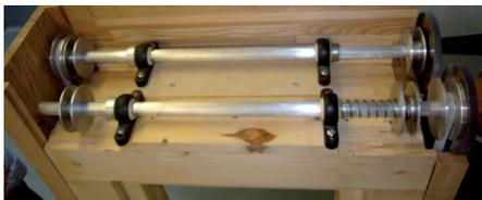
**Bild 4.15** Variable Kopplung beider Wellen mit einer Zahnradverbindung
