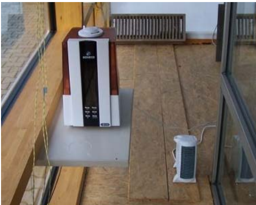
Abb. 79 Luftbefeuchter und Heizlüfter im Innenraum der Testfassade
