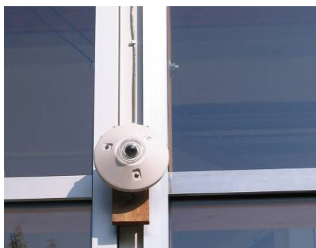
Abb. 78 Solarimeter an der Testfassade
